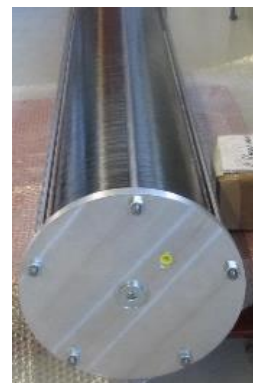
Prototyp eines leichten und biegbaren Kolbenspeichers aus kohlenstofffaserverstärktem Kunststoff (CFK) für den Einsatz in einem Schwungradsystem Foto: WETI
