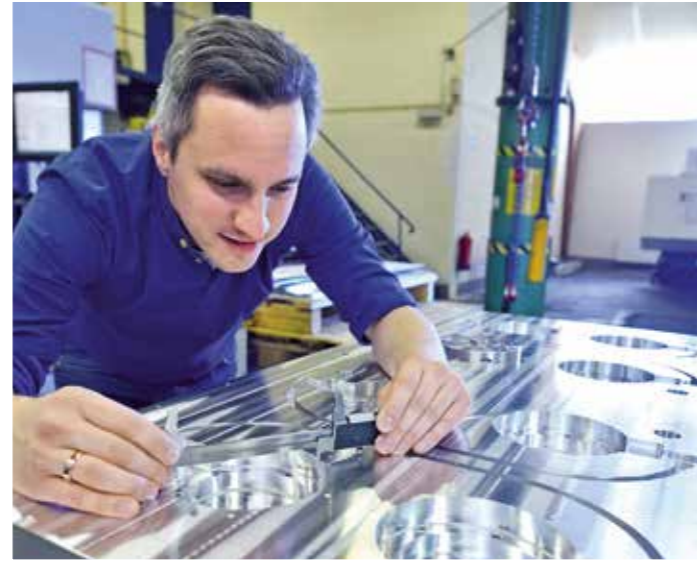
KONTROLLE: Fertigungsplaner Hanno von Borgstede vermisst ein gefrästes Werkstück mit der Schieblehre.
