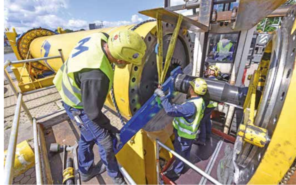
MONTAGE: Am Kai im Harburger Hafen wird ein Hydraulikhammer von Menck zusammengesetzt.
