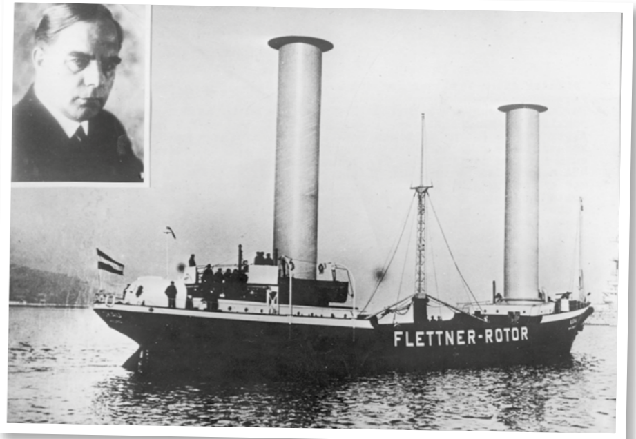
DAS ERSTE SCHIFF MIT ROTORSEGEL: Der Ingenieur Anton Flettner (1885–1961) ließ das Segelschiff „Buckau“ 1924 auf der Kieler Germaniawerft nach seinen Vorgaben umbauen und führte damit den Nachweis, dass das Prinzip funktioniert.
