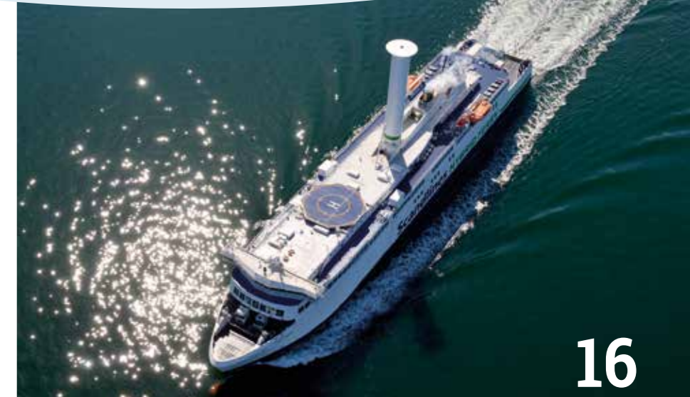
OSTSEEFÄHRE „COPENHAGEN“: Das hohe Rohr auf dem Deck wirkt wie ein Schornstein, ist aber ein Rotorsegel, das die Kraft des Windes nutzt und so beim Energiesparen hilft.
