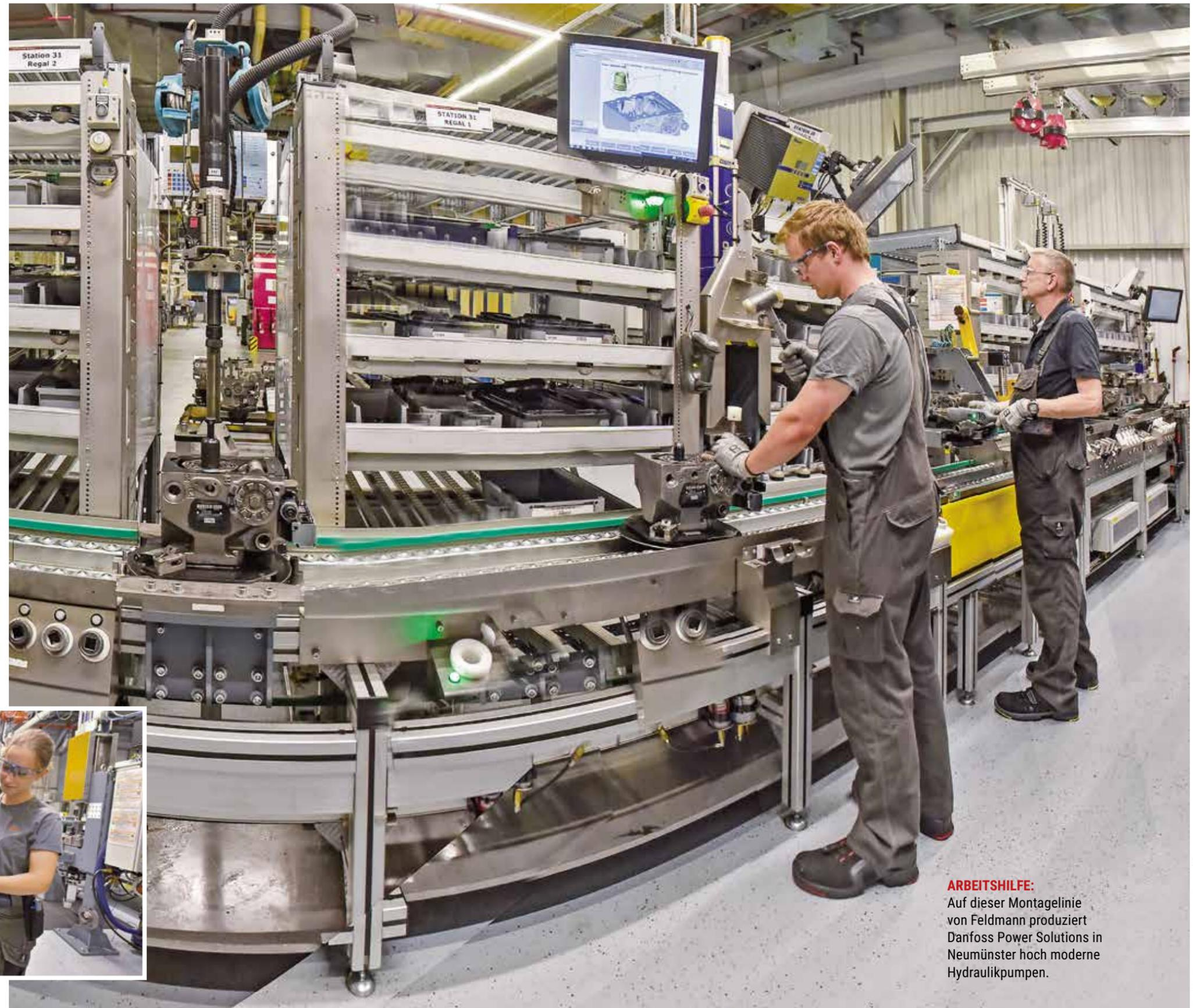
**ARBEITSHILFE:** Auf dieser Montagelinie von Feldmann produziert Danfoss Power Solutions in Neumünster hoch moderne Hydraulikpumpen.
