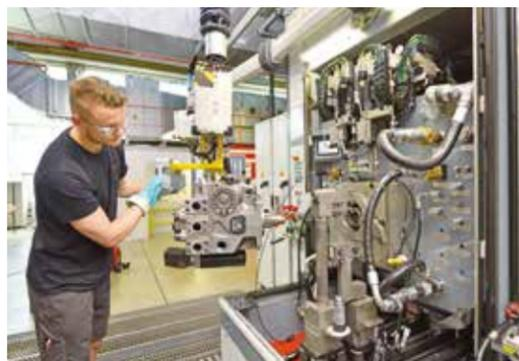
**HOCHDRUCK-HIGHTECH:** Danfoss-Mitarbeiter Chris Lochefeld hebt eine Pumpe auf den Prüfstand.
