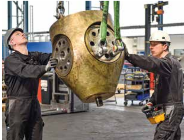
SCHWERER BROCKEN: Die Nabe eines Verstellpropellers.
