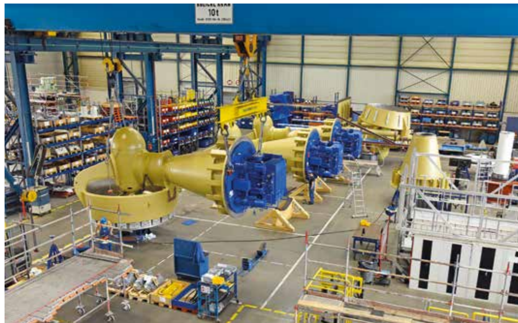
BLICK IN DIE MONTAGEHALLE: Vier große Ruderpropeller für einen Kunden aus dem asiatischen Raum.
