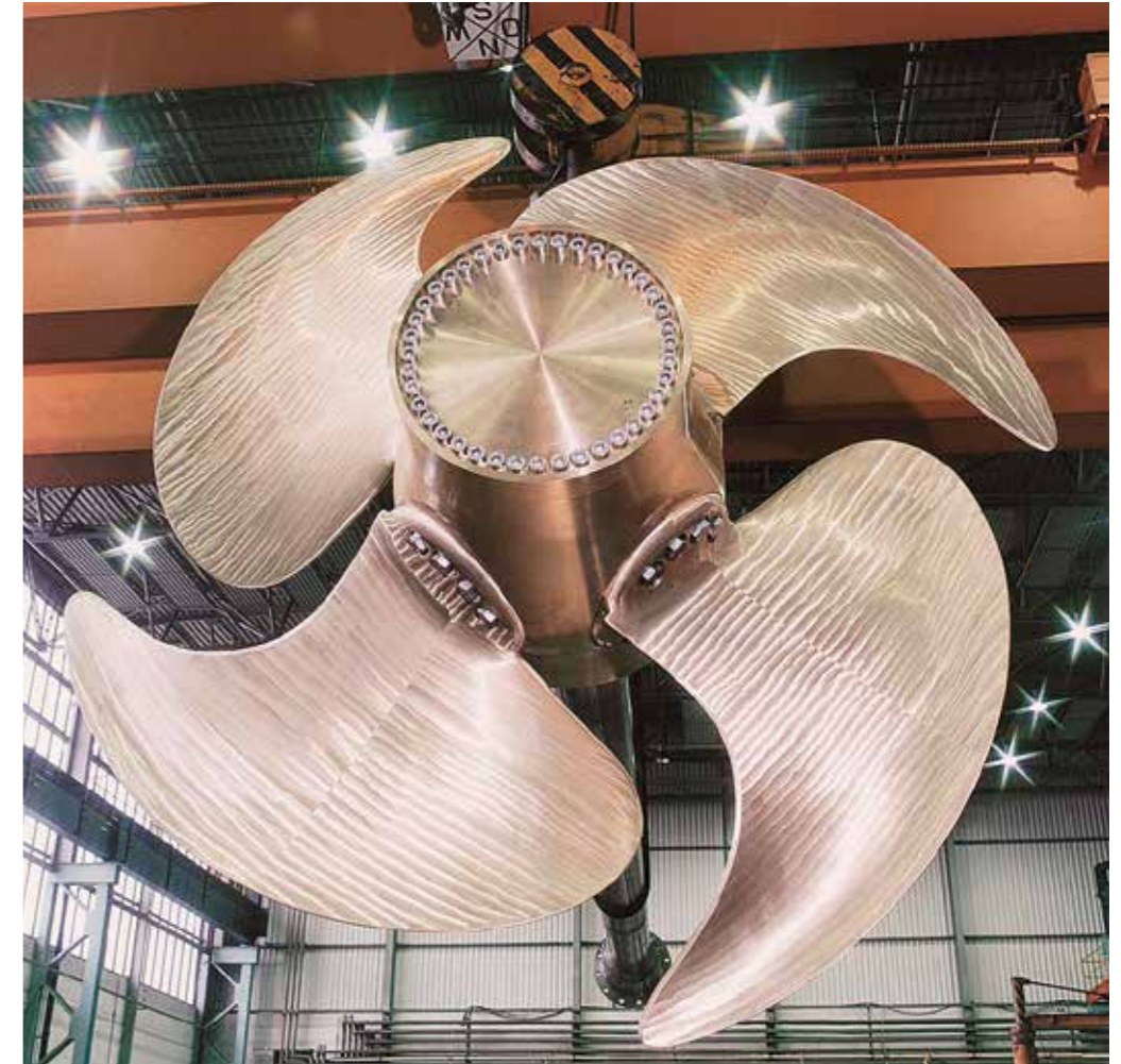
MÄCHTIGER ANTRIEB: Ein Verstellpropeller von Schottel mit Flügeln, deren Steigung verstellbar ist.
