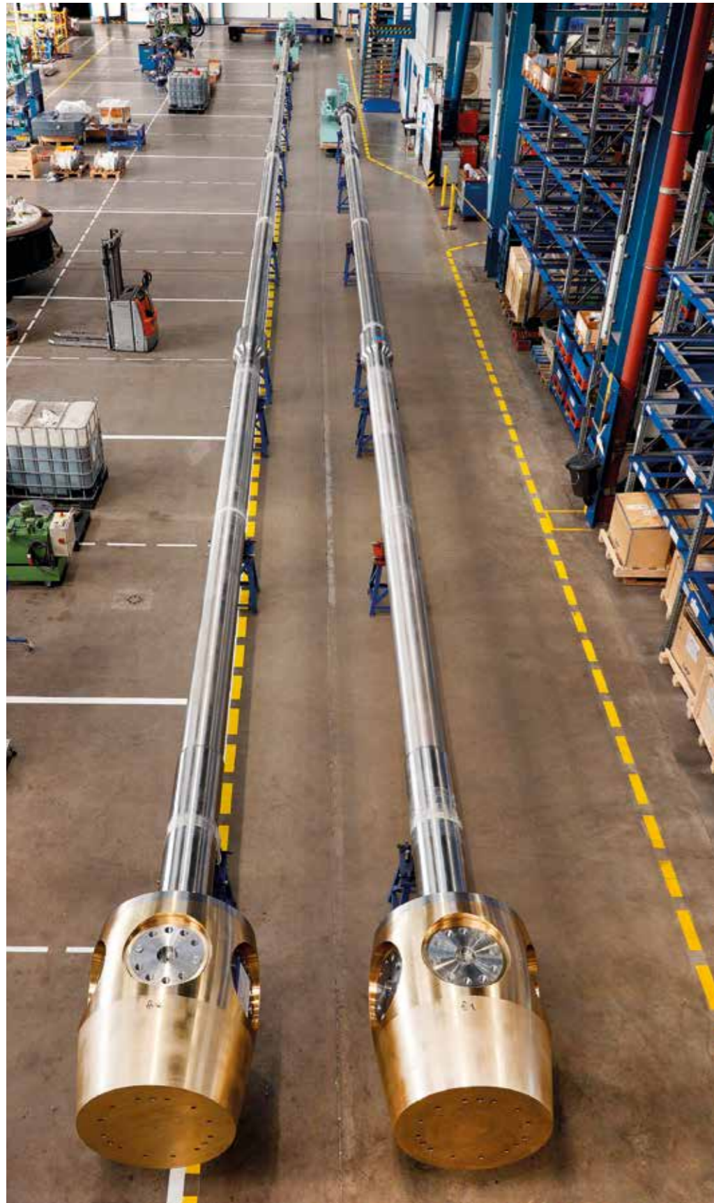
IMPOSANT: Bei der Produktion solcher Propellerwellen kommt eine riesige Drehbank zum Einsatz.
