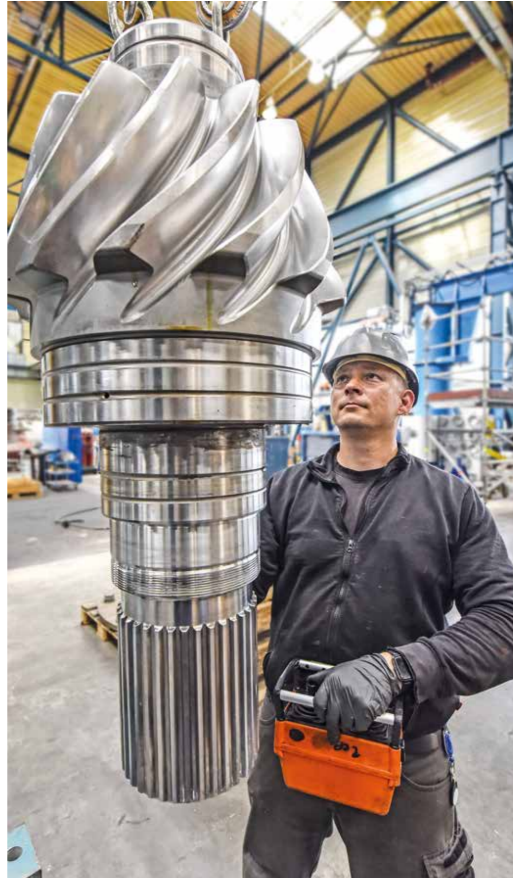
AM HAKEN: Ein Getriebe-Bauteil für einen Ruderpropeller.
