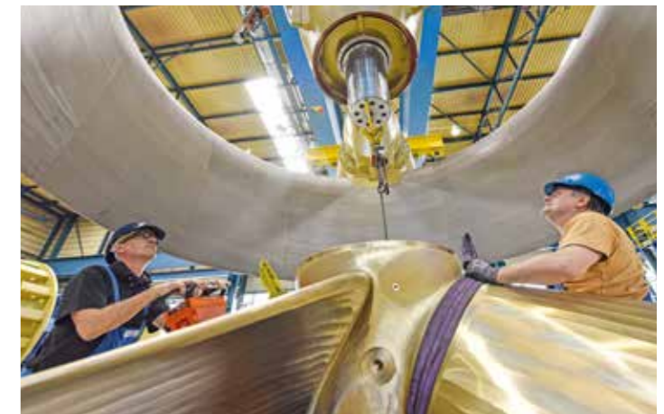
ARBEIT MIT AUGENMASS: Ein großer Propeller wird eingehängt.
