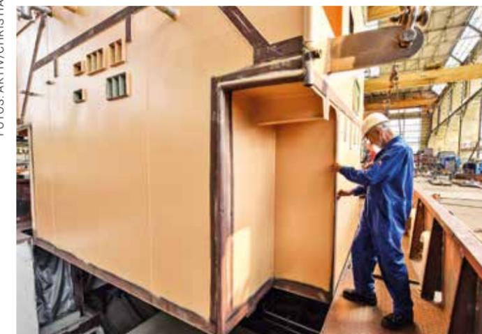
**PASSGENAU:** Dadurch, dass Deckshaus und Schiff getrennt gebaut wurden, konnte der Neubau viel schneller fertiggestellt werden.
