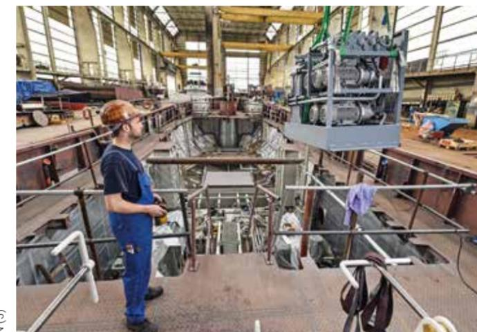
**KOMPAKTES KRAFTPAKET:** Der Block mit der Ruderhydraulik für das Planierschiff wird mit dem Hallenkran in den Maschinenraum gehoben.
