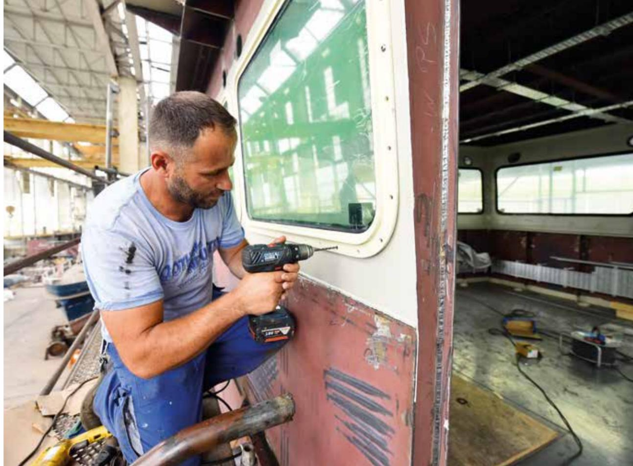
**ARBEITEN AM STEUERHAUS:** Ein Mitarbeiter setzt die Bohrlöcher für die Fenster des Deckshauses, das später als fertiges Modul auf das Planierschiff gehoben wird.
