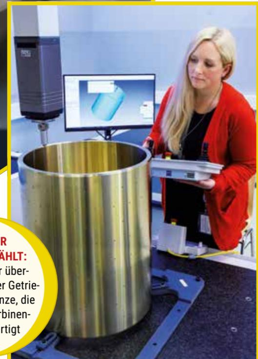
**WENN JEDER MIKROMETER ZÄHLT:** Marina Schlömer überprüft die Maße einer Getriebebuchse aus Bronze, die für einen Windturbinen-Hersteller gefertigt wurde.
