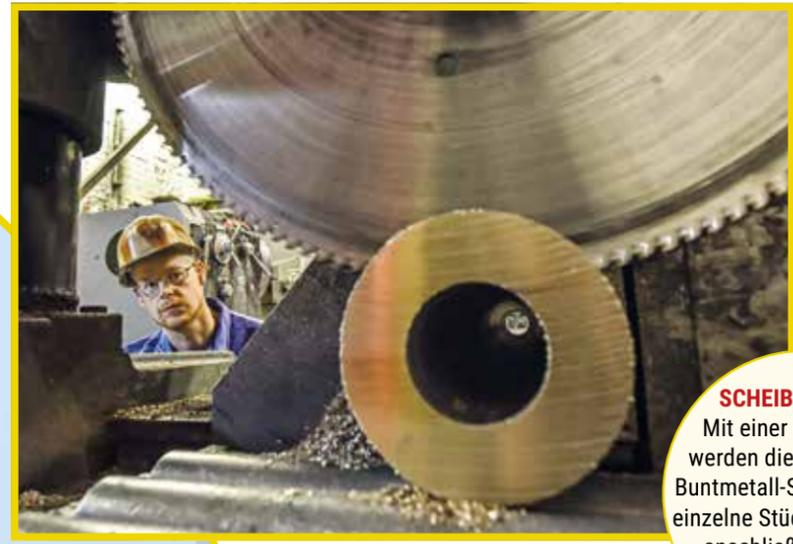
**SCHEIBENWEISE:** Mit einer große Säge werden die gegossenen Buntmetall-Strangprofile in einzelne Stücke gesägt, die anschließend weiterbearbeitet werden.
