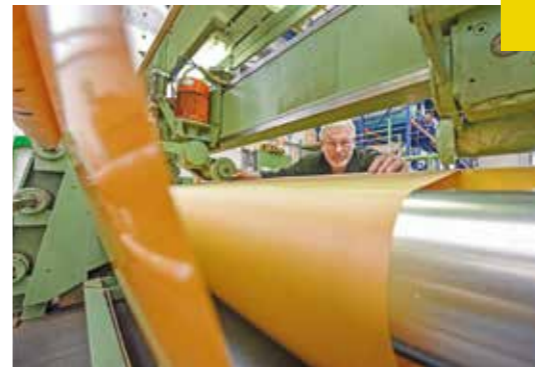
VORBEREITUNG FÜR DEN ZUSCHNITT: Cay Wilkens an einer Maschine, auf der Kunststoffbahnen für die Transportbänder konfektioniert werden.
