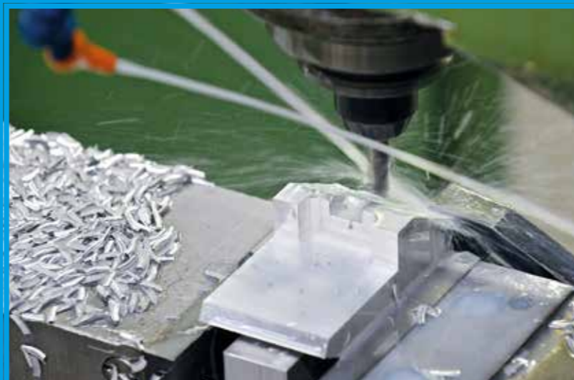
MILLIMETERGENAU: Der Alu-Block wird mit der Fräsmaschine in Form gebracht und später eloxiert.
