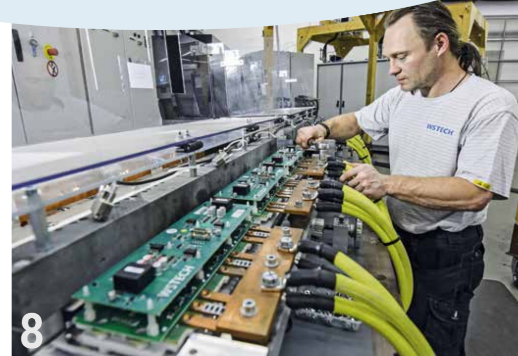
PRÄZISE ARBEIT: Thorsten Anders fixiert bei WSTECH Stromkabel an Leistungsmodulen.
