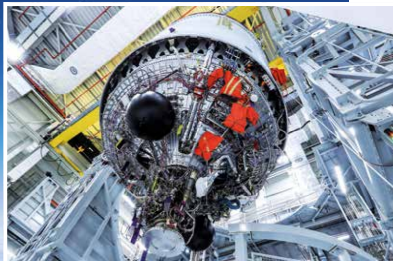
ORDENTLICH POWER FÜR DEN ORBIT: Die 12 Meter lange Oberstufe der Ariane 6, fotografiert von unten.
