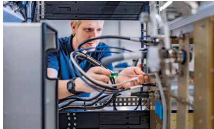
HIGHTECH: Montagearbeit an einem 1-Kilowatt-Sender vom Typ „TRX 3100“, der später Teil einer Kommunikationsanlage wird.
