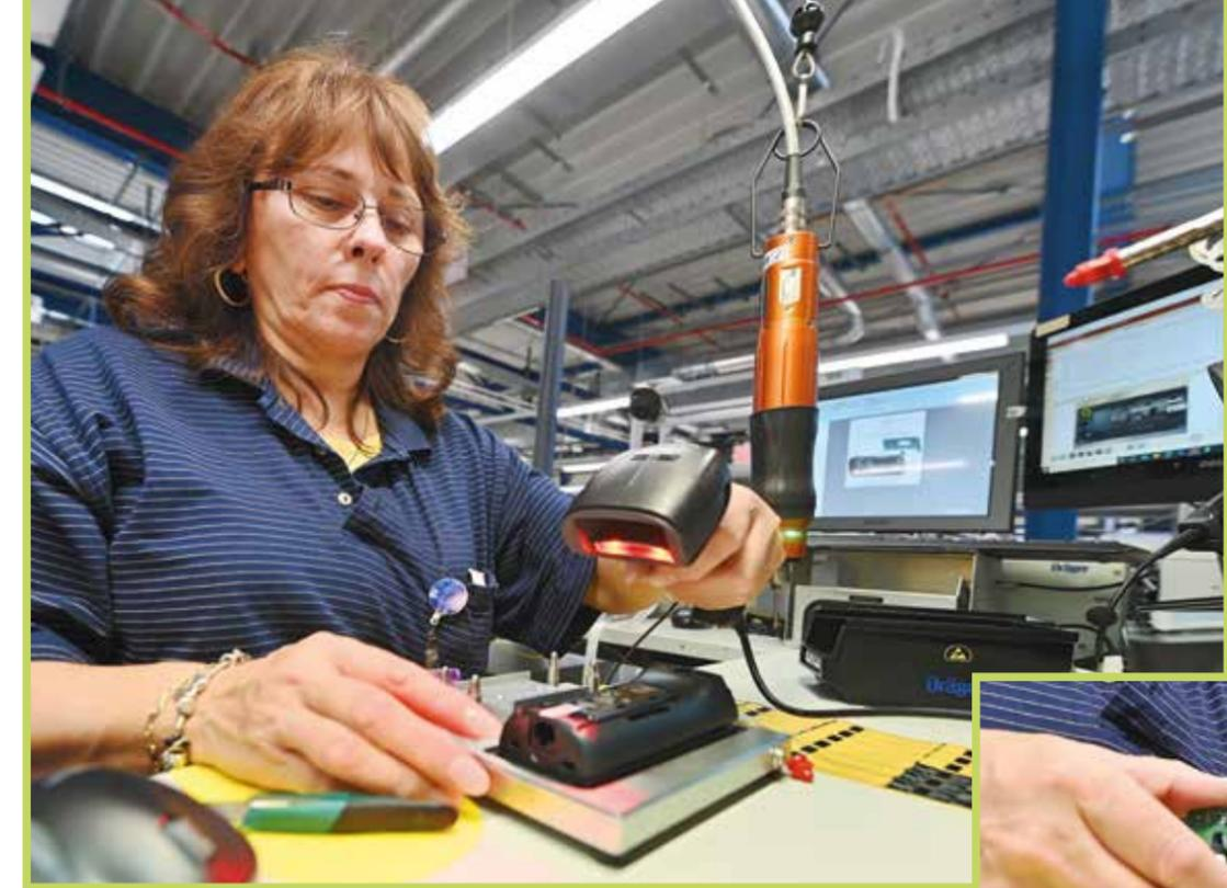
**FILIGRANE ARBEIT:** Eine Mitarbeiterin prüft das Handteil des Interlocks (links). Zuvor hat sie die Platine mit Elektronik und Sensor in die Gehäuseschale eingebaut.
