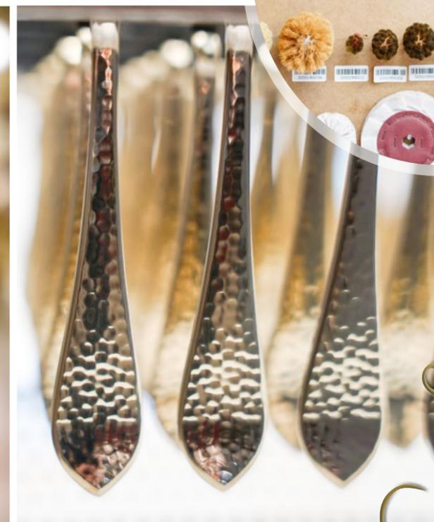
Hämmern und Polieren: Damit Besteck und Geschirr ihr unverwechselbares Design erhalten, werden sie mit unterschiedlichsten Hämmern bearbeitet und mit Textilscheiben in verschiedenen Ausführungen poliert.
