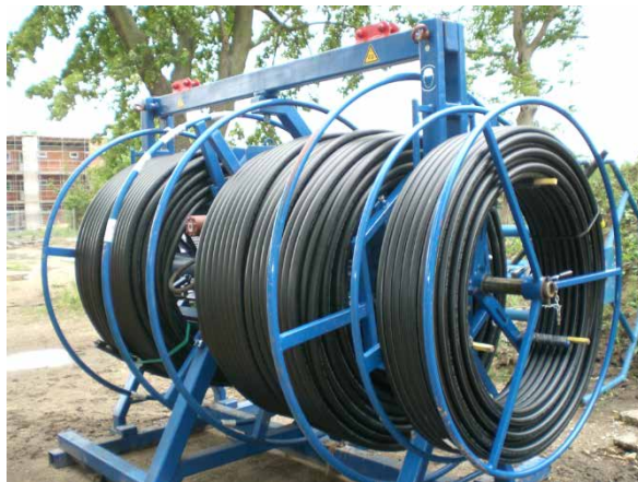
EWS auf Spindeln (Quelle: Bundesverband Geothermie)
