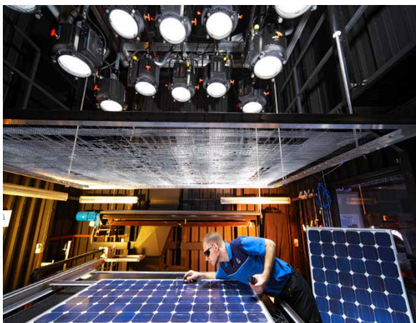
Prüfung von Solarzellen (Quelle: Thomas Ernsting/LAIF)
