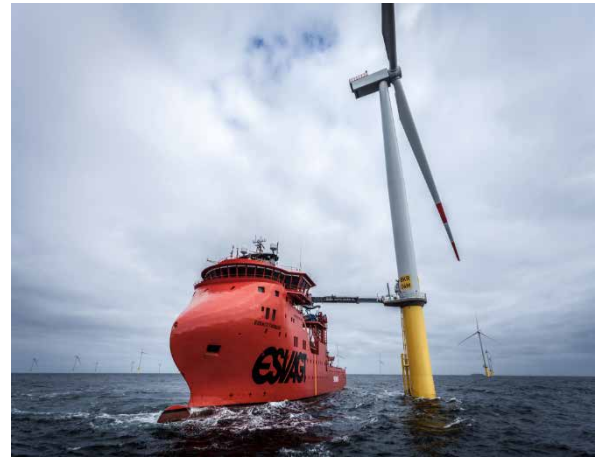
Spezialschiff für Wartungsarbeiten (Quelle: Siemens AG)
