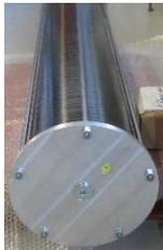
Der erste Prototyp des Leichtbauspeichers wird derzeit auf dem Testfeld des Projektpartners HYDAC getestet. Es werden Versuche an Kolbenspeichern aus kohlenstofffaserverstärktem Kunststoff durchgeführt, um die Funktionalität der hydropneumatischen Kolbenspeicher in Leichtbauweise zu untersuchen. Weitere Versuche werden im kommenden Sommer angestrebt. Der zweite Prototyp, der flexibel sein wird, und sich wie ein Rotorblatt einer Windenergieanlage verbiegen lassen wird, ist derzeit in Entwicklung.
