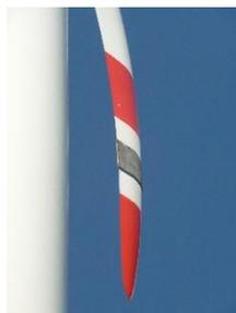
Im Projektverlauf wurden Messungen mit einem aerodynamischen Handschuh an einer Anlage der Multi-MW Klasse (Servion, MM92) auf dem Testfeld in Eggebek, etwa 20 km südlich von Flensburg, durchgeführt, um die aerodynamischen Unterschiede in den verschiedenen Größenklassen zu dokumentieren und auszu-
